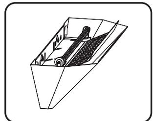
4. Schieben vorsichtig Sie die neue Klebefolie so in das Gerät, dass die Klebefolien Richtung LED-Röhre zeigt.
